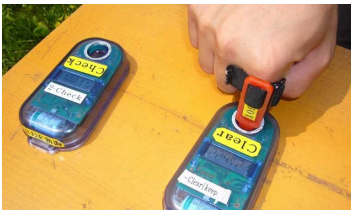
クリア:ICチップのメモリを空にします
